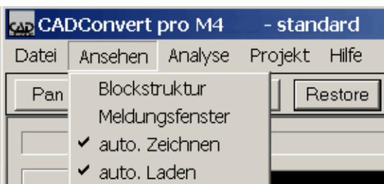
Die Option **Blockstruktur** ermöglicht es, den hierarchischen Aufbau grafisch zu betrachten. Die Struktur wird mit Hilfe von Blöcken (Geometriedefinition) dargestellt. Die Option kann AN oder AUS geschaltet werden. Die Option **Meldungsfenster** kann ebenfalls auf AN oder AUS gesetzt werden.
