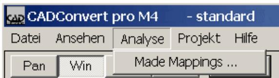
Bei der Option *Made Mappings* analysiert CADConvert pro die Layer, Linien- und Texttypen der geladenen Zeichnung und deren Bedeutungen für das zu konvertierende Format.
